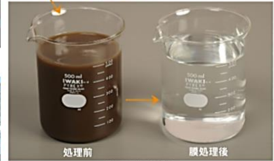
処理水対比 懸濁性浮遊物質=0mg/Lを実現します。
