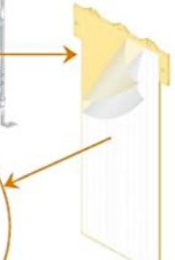
膜エレメント ろ板両面に 平膜を溶着した構造です。
